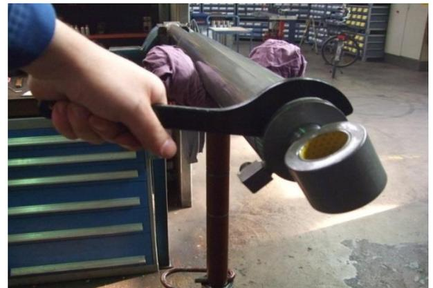
3. Entfernen Sie die Sicherungsschraube aus dem Zylinderboden und schrauben Sie den Zylinderboden aus dem Zylinderrohr heraus.
