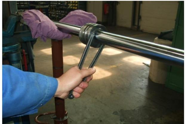
9. Erwärmen Sie die zweite Kolbenhälfte um die zweite Kolbenstange zu entfernen.
