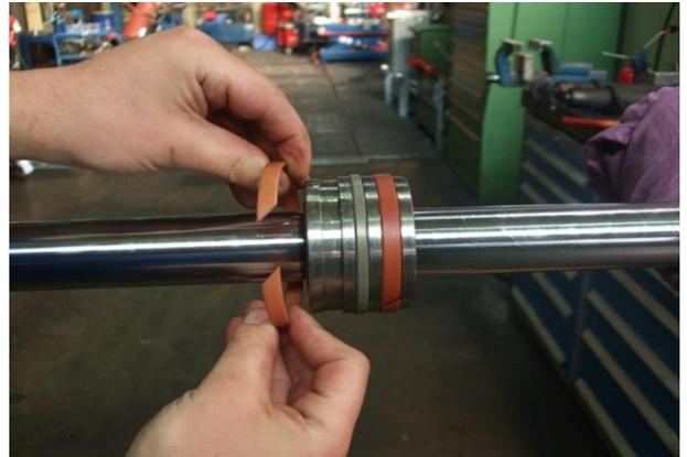
5. Entfernen Sie den Glydring der zweiteiligen Kolbendichtung.
