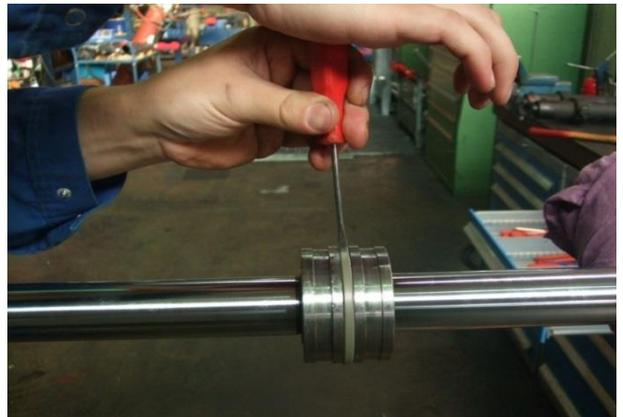
6. Entfernen Sie den O-Ring der zweiteiligen Kolbendichtung.
