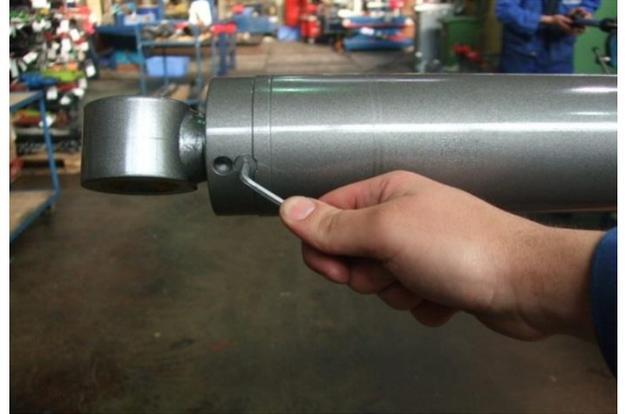
2. Öffnen Sie die Führungsmutter und ziehen Sie die Kolbenstange aus dem Zylinderrohr heraus.
