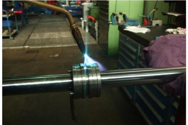
8. Lösen Sie den erwärmten Kolben mit dem Schlüssel
